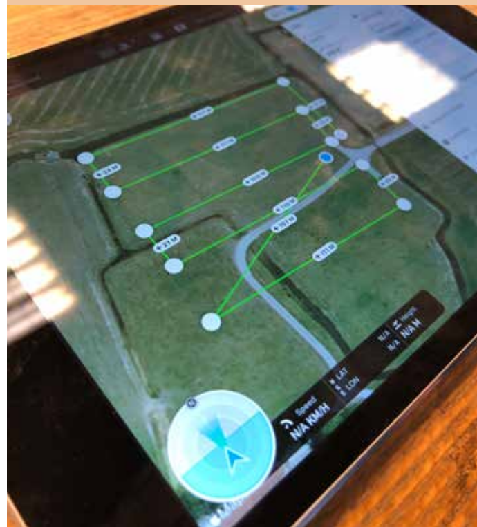
Via een tablet wordt de vliegroute van de drone geprogrammeerd.
